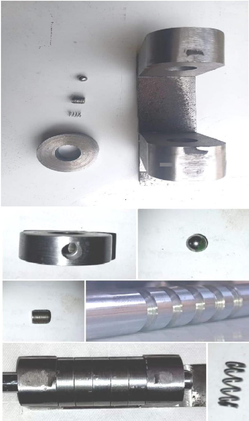
Figure III.16: Vue éclate de la serrure réelle
