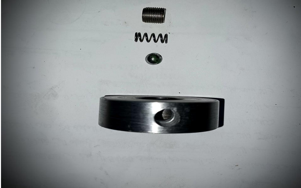
Figure III.12:Vue réel de l'écrou, ressort, bille
