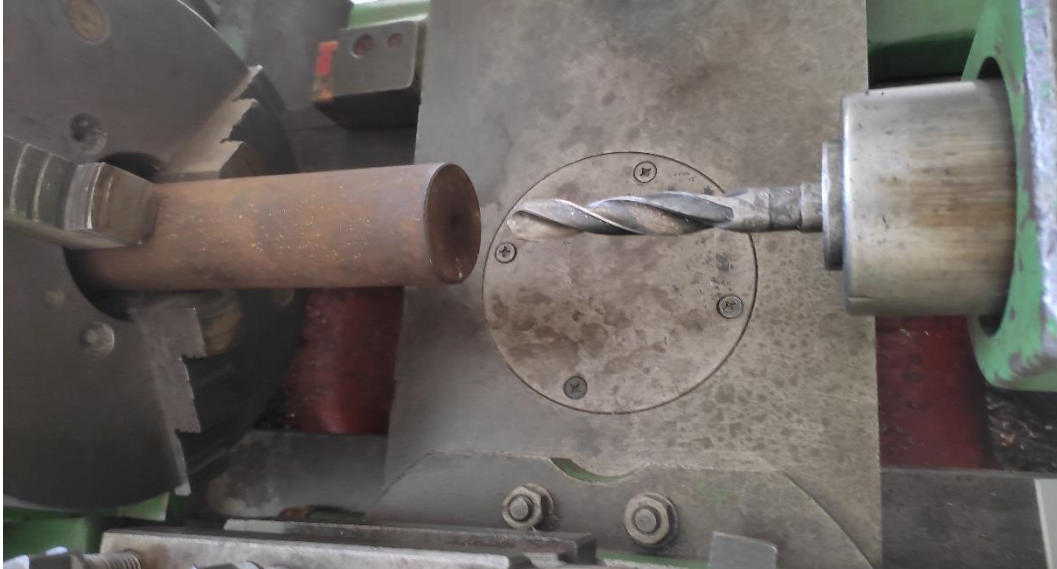
Figure III.6: Processus de perçage de l'écrou
