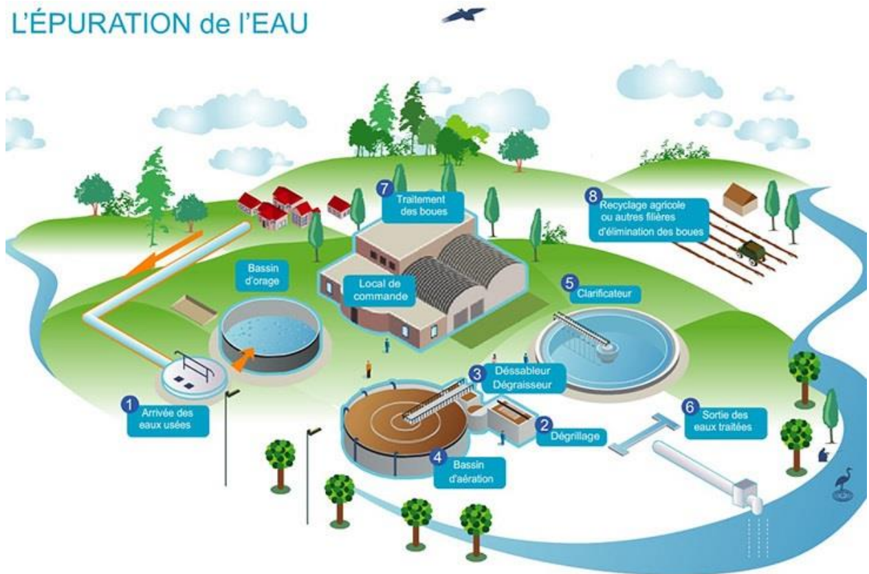
1 Figure II .01 : Station d'épuration des eaux usées.
