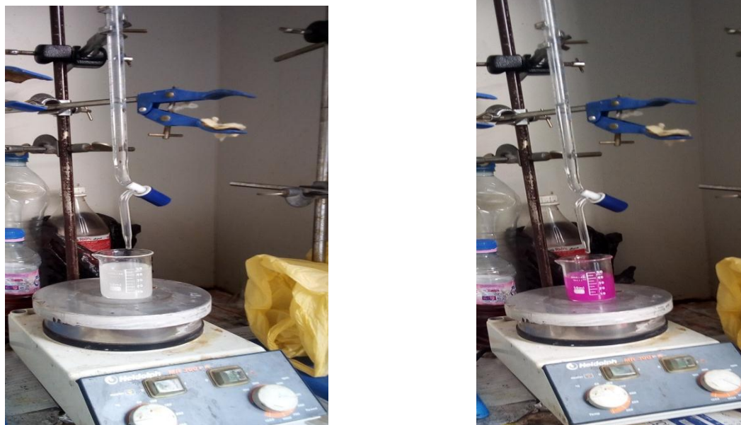
Figure III.12: Dosage en retour pour déterminer l'indice d'acidité.
