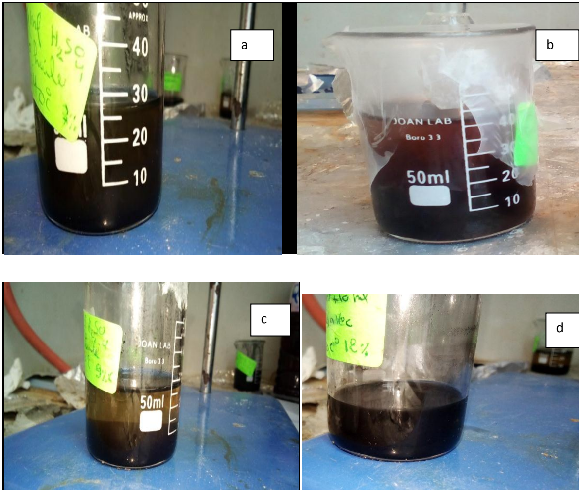
Figure IV.10: Effet du poids de charbon actif (a) 3% de charbon active ;(b) 6% de charbon active;(c) 9% de charbon active ;(d) 12% de charbon active.
