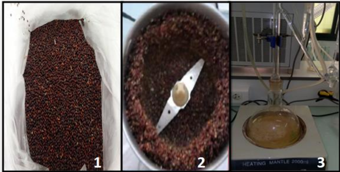
Figure 05 : l'extraction d'huile essentielle des graines de Brassica spp. (1-rinçage et séchage des graines.2-broyage des grains. 3- Appareil hydrodistillation Clevenger ).
