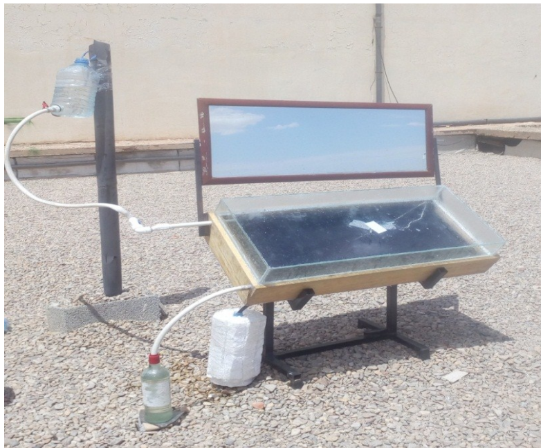
Figure III.2 - Installation expérimentale de distillateur solaire à mèche avec un réflecteur externe.
