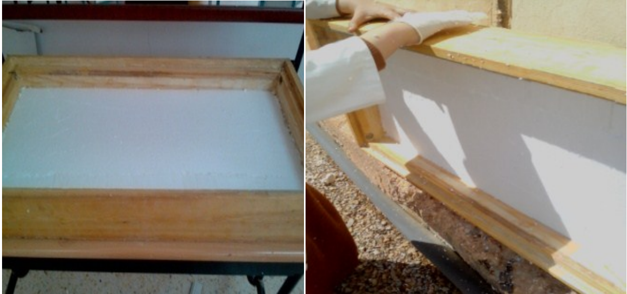
Figure III .7 - Coffre avec l'isolant en polystyrène.
