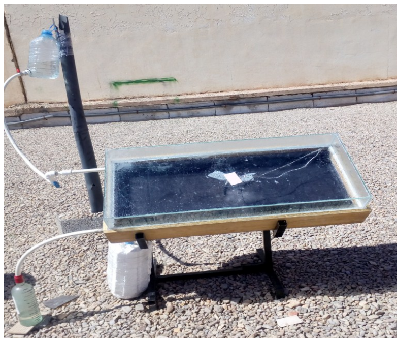
Figure III.3 - Installation expérimentale de distillateur solaire à mèche sans réflecteur.
