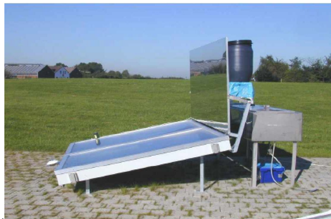
Figure II.2 - Modèle de distillateur solaire à plusieurs étages [10].
