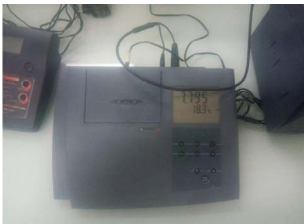
Photos III.1: Conductimètre (outil de mesure de la conductivité électrique) (Garti et Hireche, 2021)
