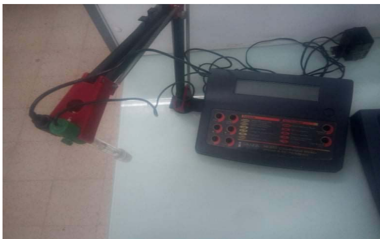
Photos III.2: pH mètre (outil de mesure du pH du sol) (Garti et Hireche, 2021)
