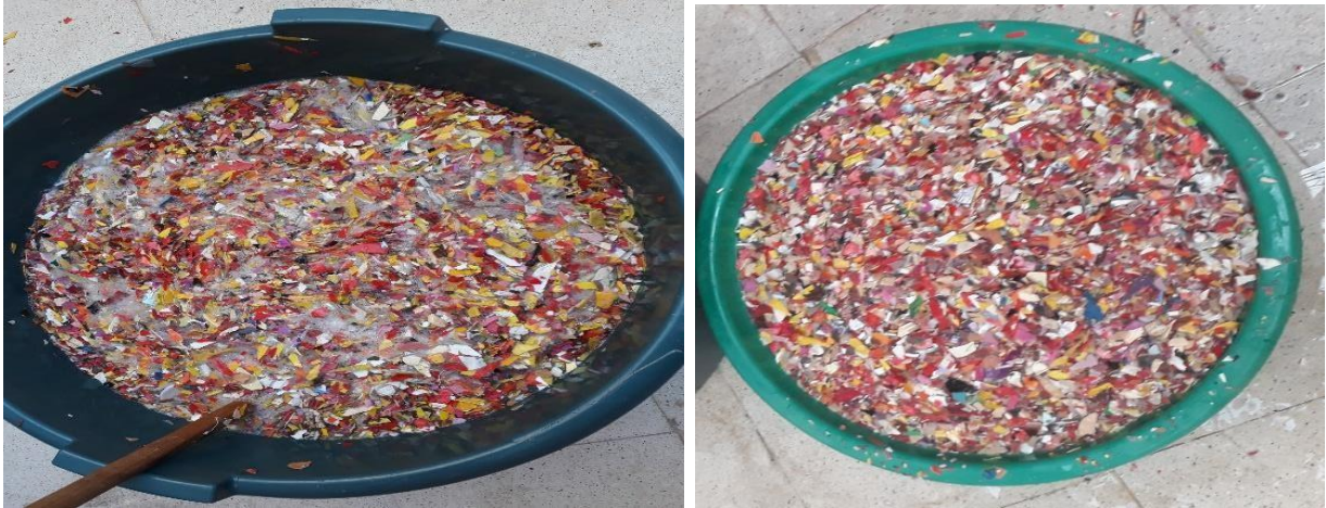
Figure III - 3 : Procédure de nettoyage et séchage de déchets plastique (a) Nettoyage (b) séchage
