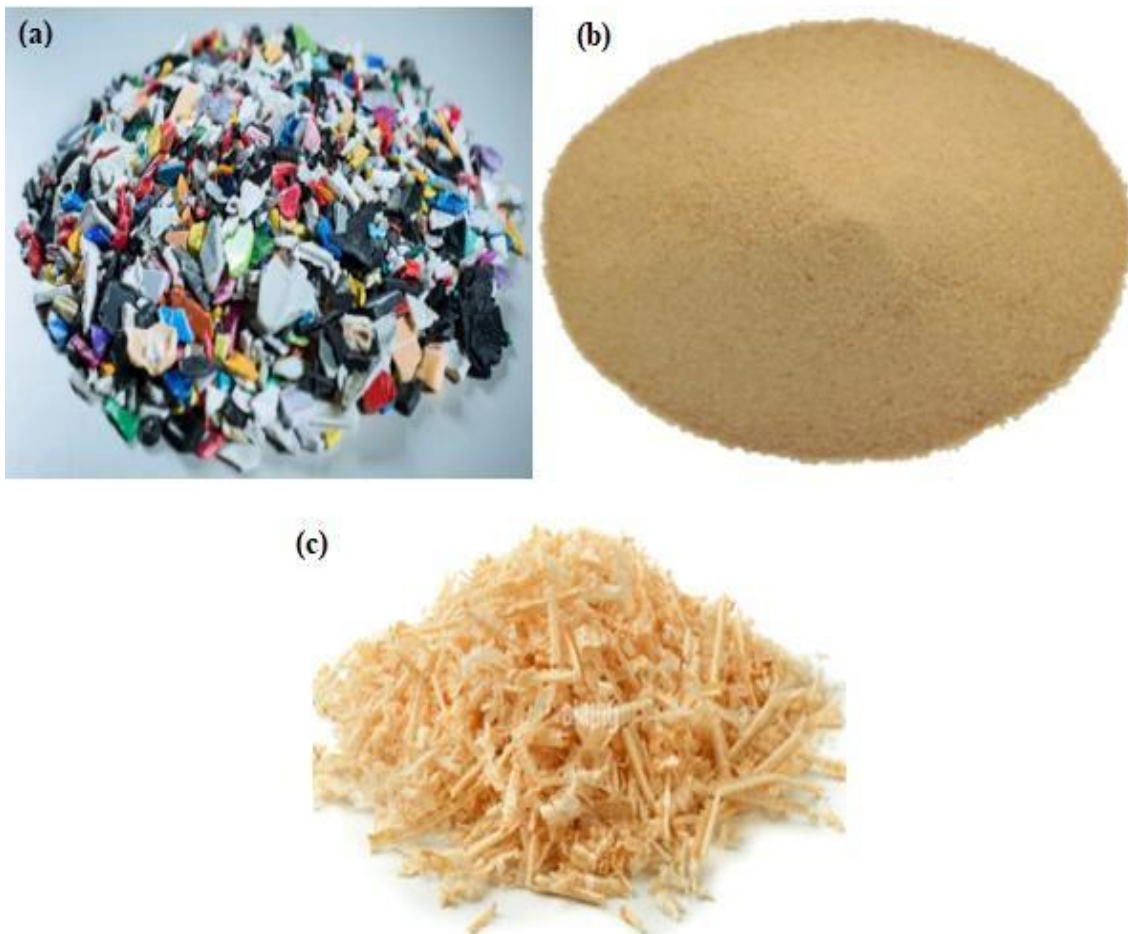
Figure III -1 : (a) Déchets plastiques PP, (b) Sable fin, (c) Sciure de bois.
