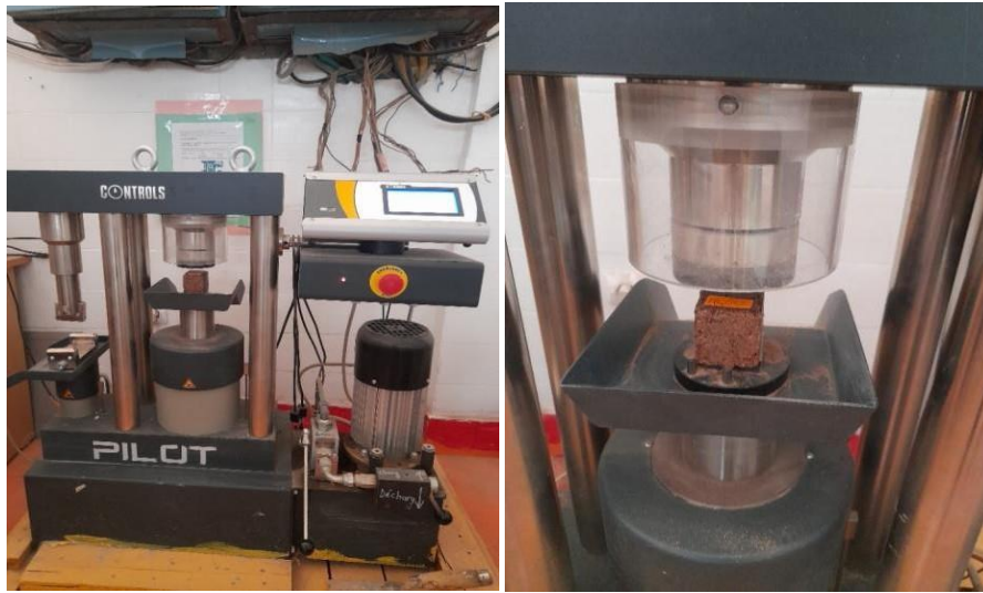
Figure III -13 : L'essai de résistance à la compression
