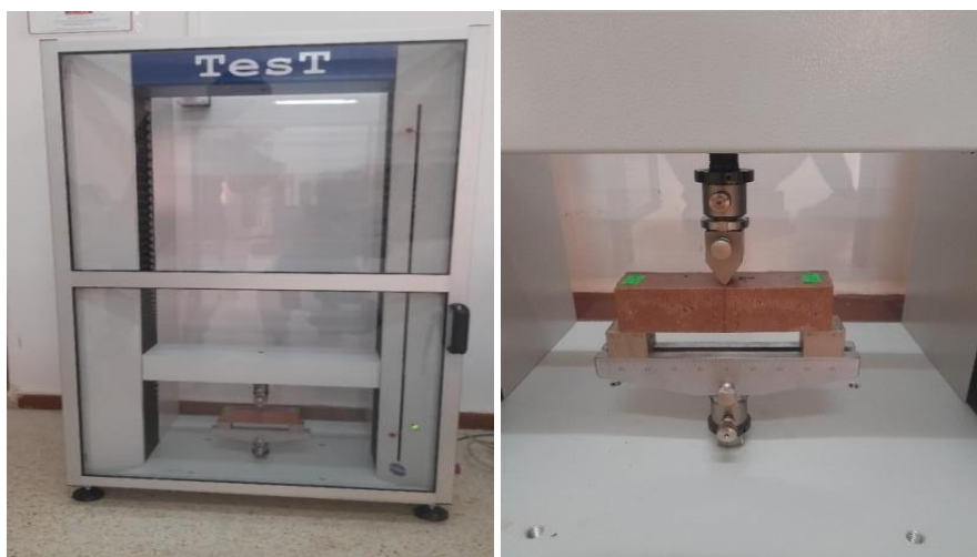
Figure III -12 : L'essai de résistance à la flexion
