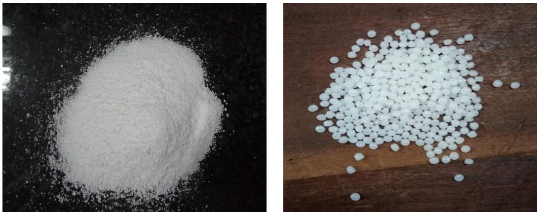
(a) PEHD TR-402 sous forme de poudre (b) PEHD TR-402 sous forme de granules
