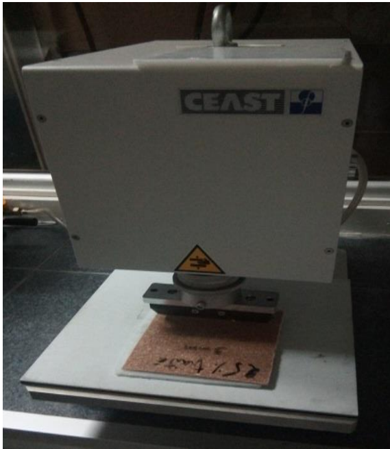
(a) Poinçonneuse de marque CEAST type 6053
