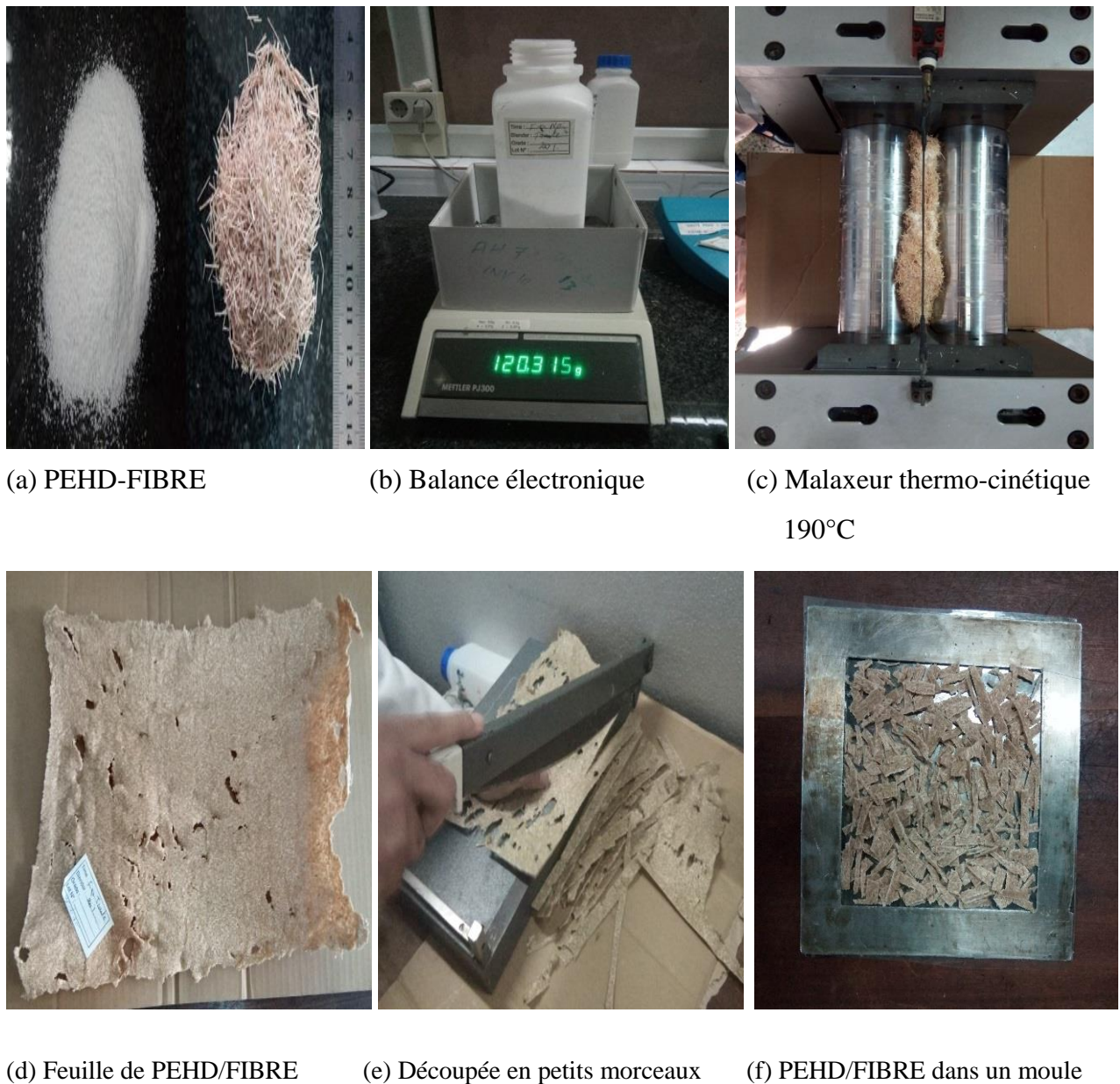
Figure III.5 : Appareillages et méthodes de préparation de mélange PEHD/FIBRES.
