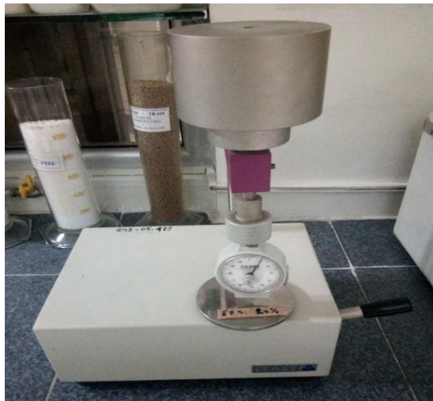
Figure III.10 : Appareillage de mesure de la dureté Shore D D2240.
