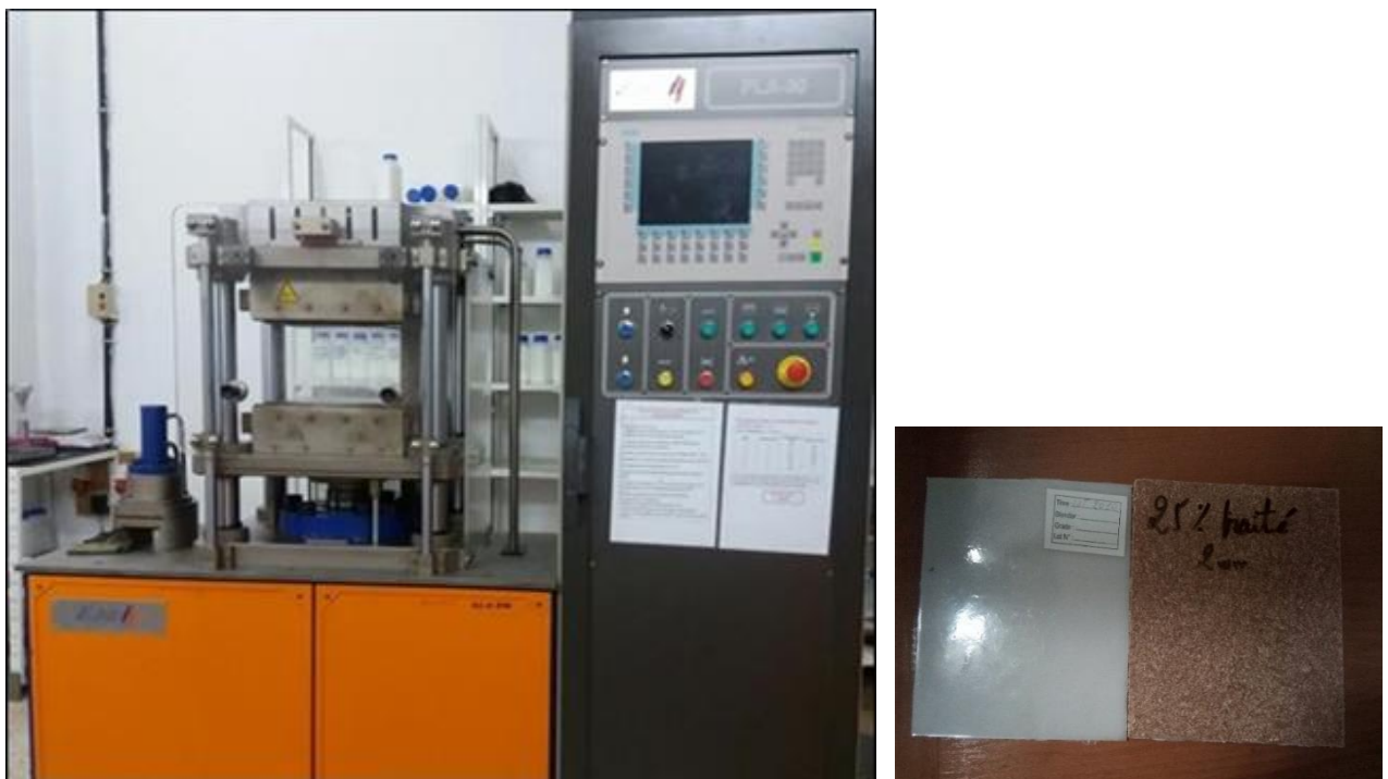
(a) Photo représentatif d'une presse hydraulique Thermo-compression automatique.
