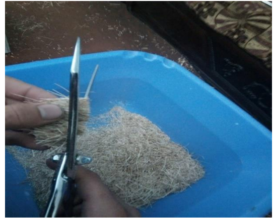
(b) Découpage de fibres (5mm)
