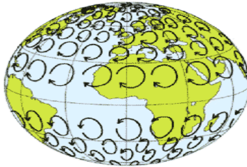
Fig. I-1: Effet de la force de Coriolis sur l'écoulement de vent
