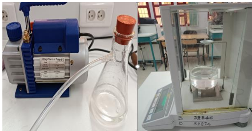
الشكل (II. 10): مضخة تفريغ العينات من الهواء وقياس كتلة العينات داخل الماء المقطر
