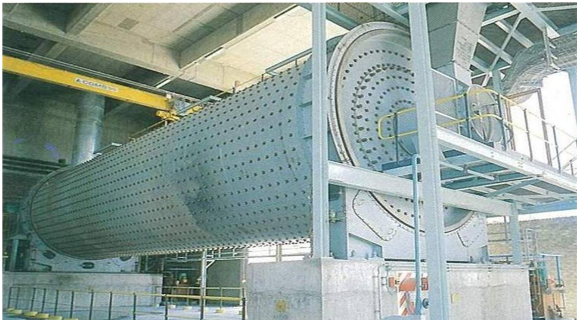
Figure (II.1) : Broyeur à boulets.
