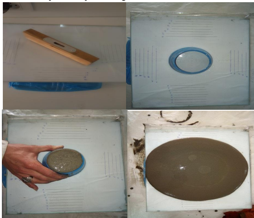
Figure (II-14) : Les étapes de essai au mini cône d'étalement.
