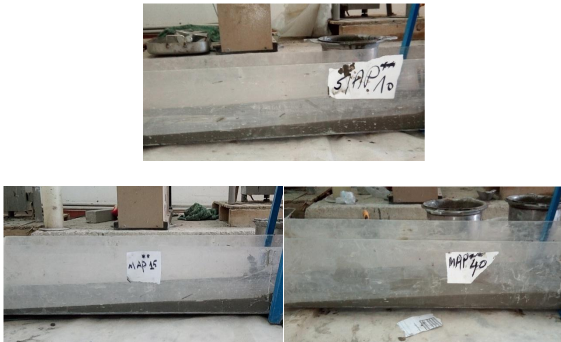
Figure (II-21) : Photos montrant la planéité de la surface libre des différents mélanges
