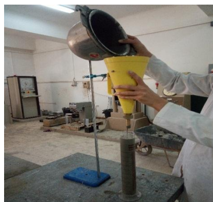
Figure (II-12) : Essais du Taux de saturation.
