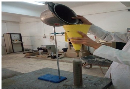
Figure (I-8) : Essais au Cône de Marsh (Essai de saturation).
