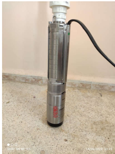
Figure (IV.4): Schéma de la pompe immergé
