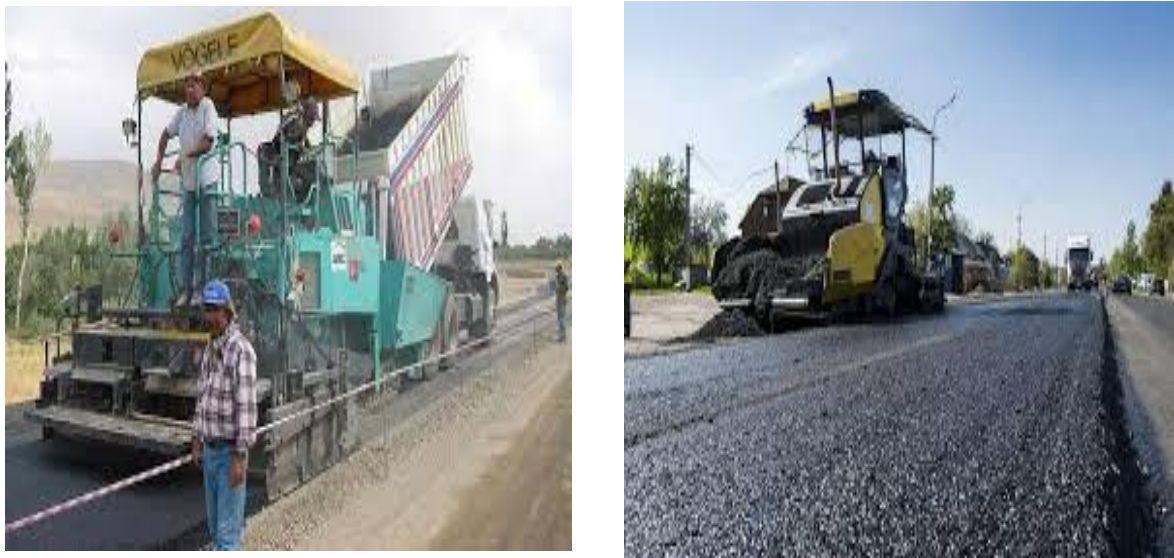
Figure VI.5. Machine de goudronnage.
