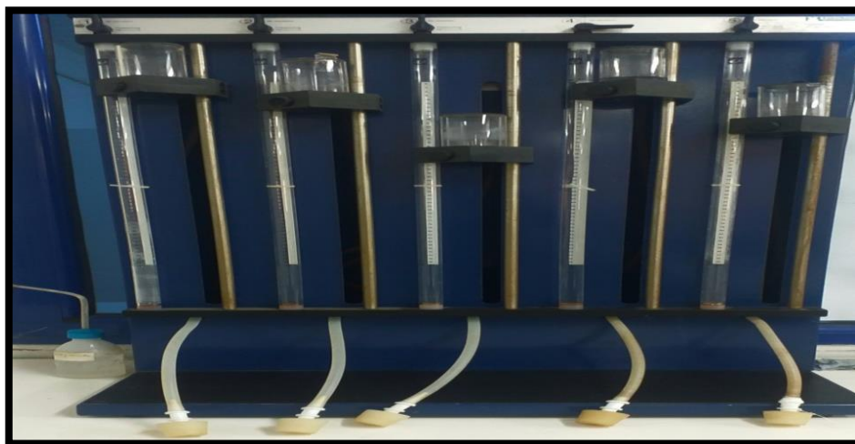
Photos 3.7: Calcimètre de Bernard de laboratoire de pédologie
