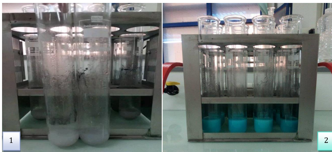
Photos 3.14 : Couleur des échantillons avant(1) et après(2) la digestion ( photos original )
