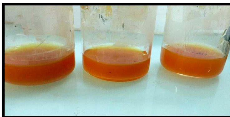
Photos 3.15 : couleur des échantillons après titrage aux nitrates d'argent ( photos original )
