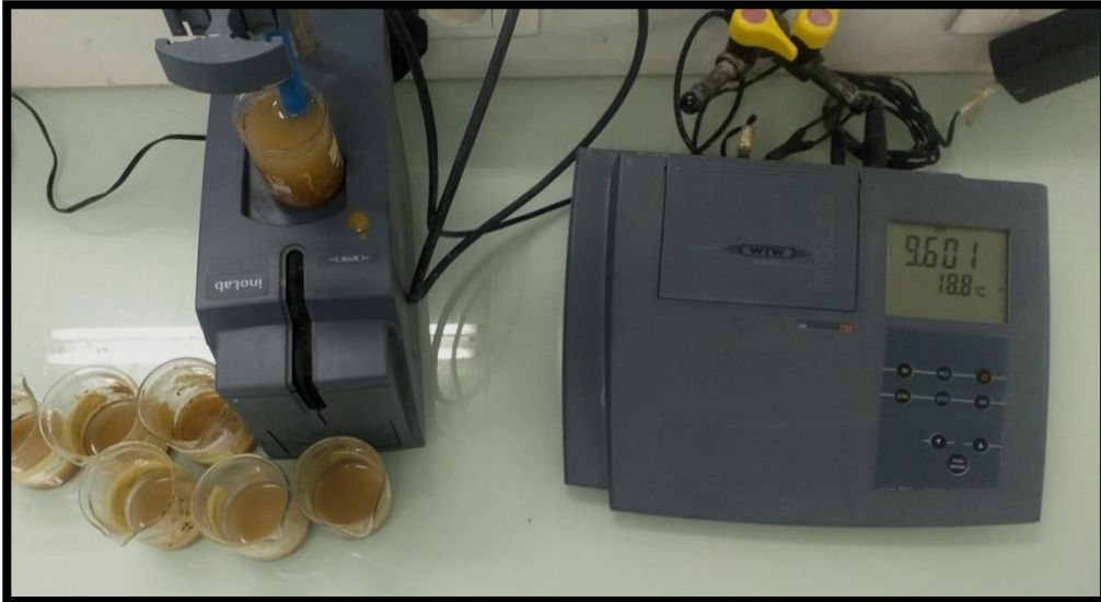
Photos 3.5: pH mètre (utilisé pour la mesure de pH de nos sols au laboratoire) (Photo originale)
