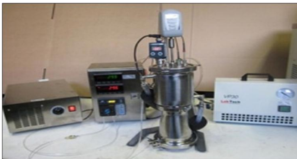
Figure 8 : Montage d'extraction par ultrasons ( Mason et al. , 2011 ).
