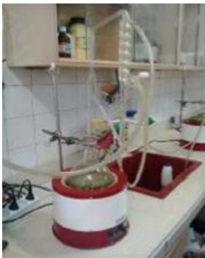
Figure 17: Montage expérimentale de l'hydrodistillation des HEs.
