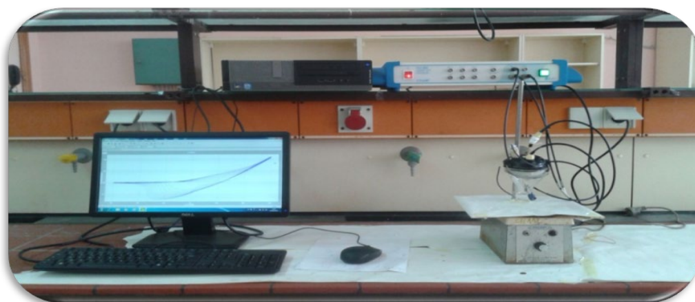
Figure II.2 : Le montage utilisé pour L'étude électrochimique.
