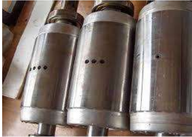
Figure I.8: Défaut rupture des barres de rotor [24].
