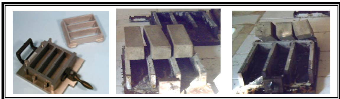
Photo. II.7: Moules pour éprouvettes de mortier
