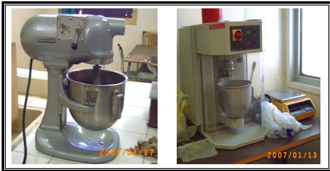
Photo .II.6: malaxeur normalisé pour pâte et mortier
