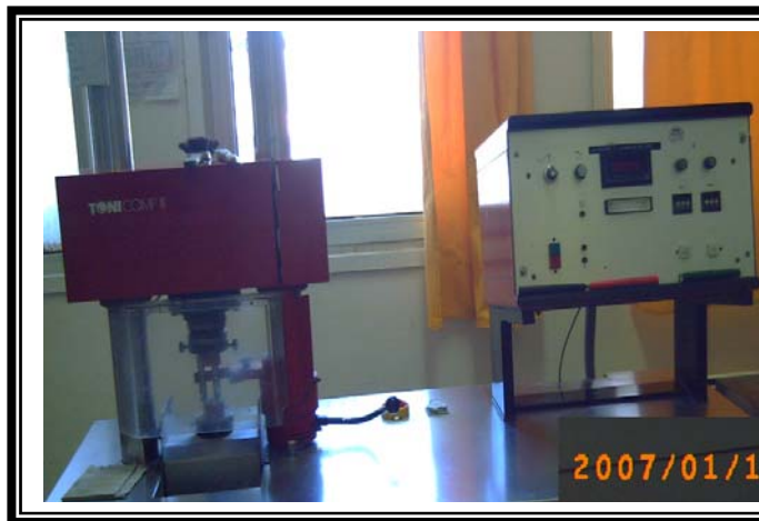
Photo. II.10 : machine d'essais à la compression
