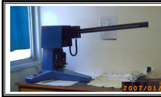
Photo. II.9 : machine d'essais de résistance à la flexion
