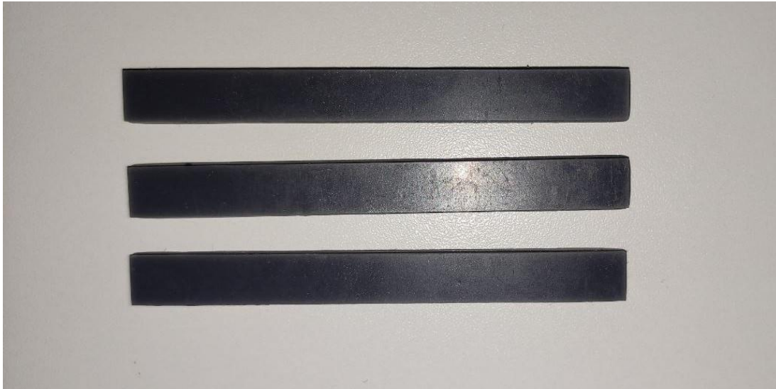
Fig. III.17. Résultat des éprouvettes de flexion imprimés par SLA
