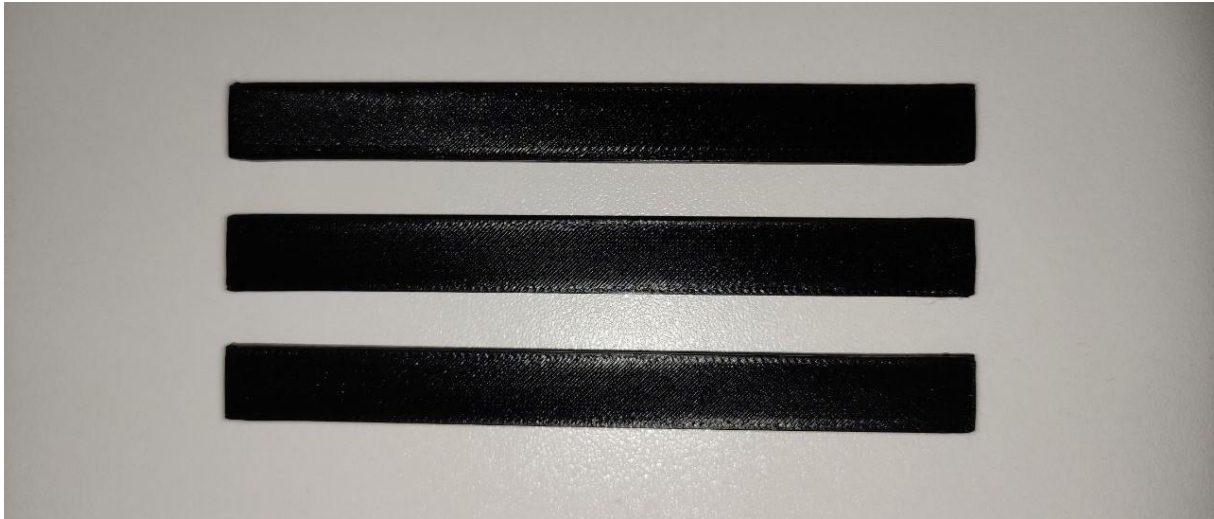
Fig. III.21. ..Résultat des éprouvettes de flexion imprimés par FDM
