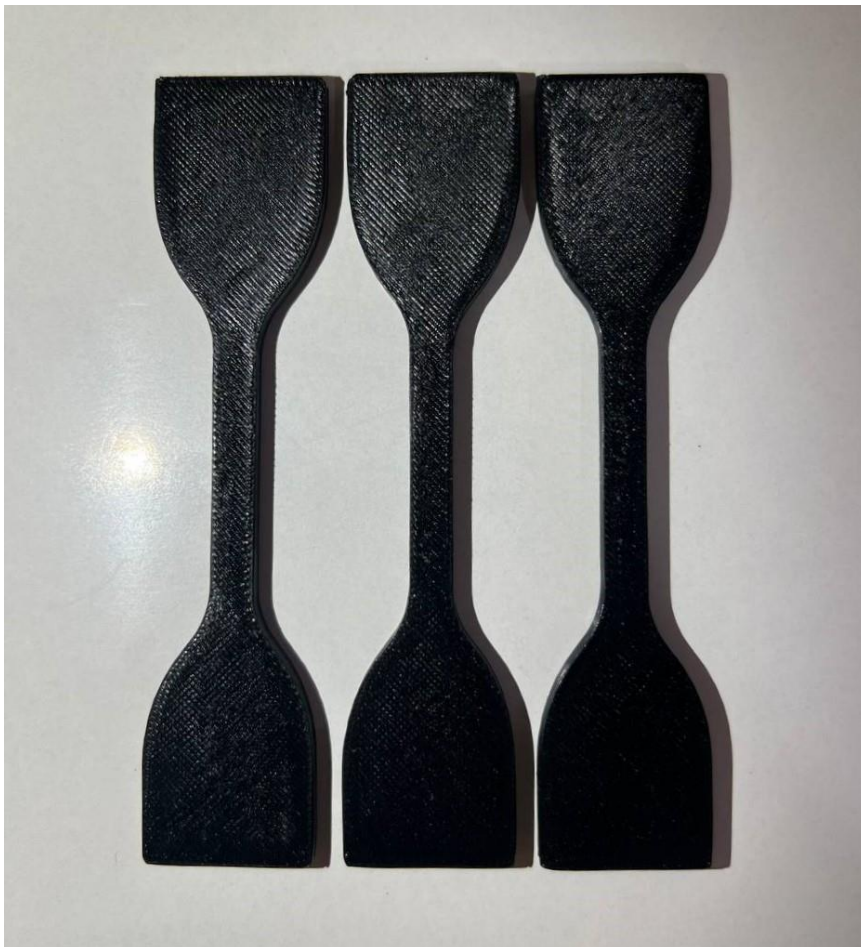
Fig. III.20. Résultat des éprouvettes de traction imprimés par FDM
