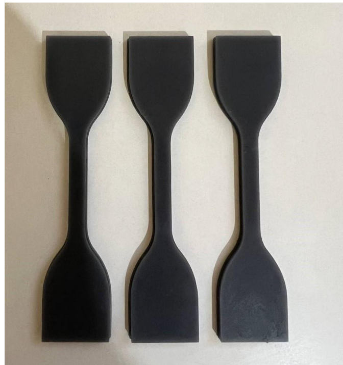
Fig. III.16. Résultat des éprouvettes de traction imprimés par SLA
