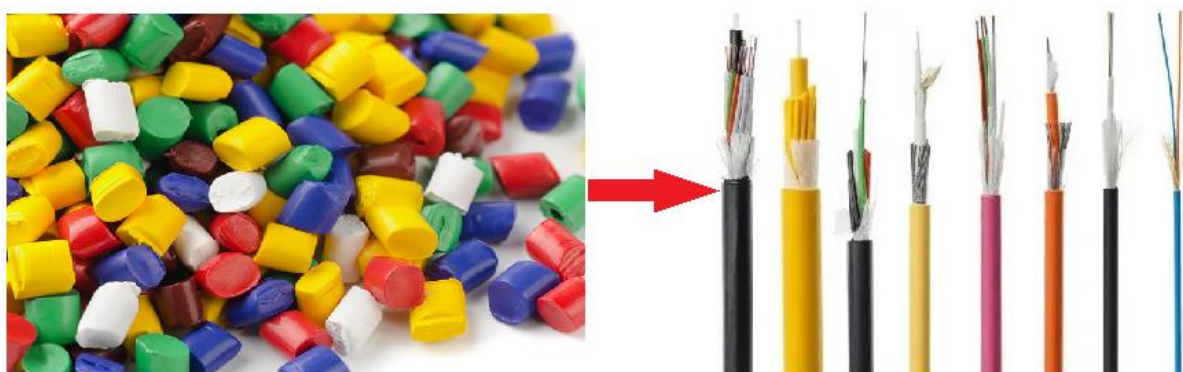
Fig. I.6. Utilisation du PVC dans la fabrication des câbles à fibres optiques
