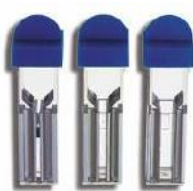
Fig. II.23: Cuvette d'électroporation avec différentes distances inter-electrodes 9 (de gauche a droite 1 mm, 2 mm et 4 mm).[34]
