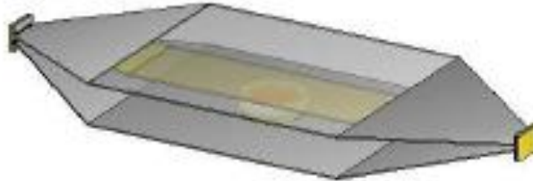
Fig III.28: Cellule TEM ouverte (ou ligne triplaquée) pour microscope, et sa modélisation .[44]
