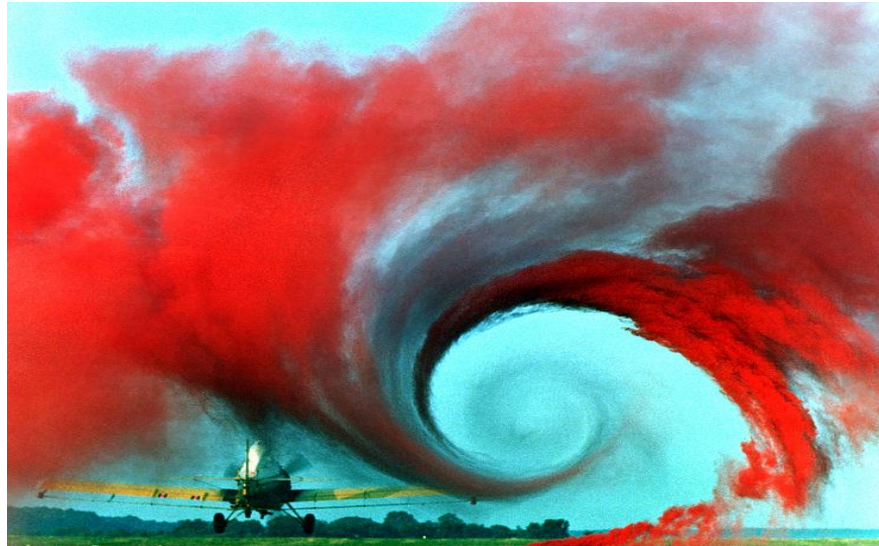
figure.III.5 : Tourbillon de bout d'aile montré par de la fumée [14]. .
