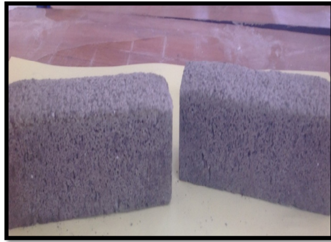
Figure III.6: Texture poreuse des mortiers à base de déchet d'aluminium.
