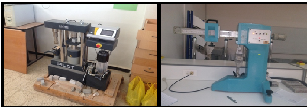
Figure II.3: Appareillage de compression et flexion-traction des mortiers
