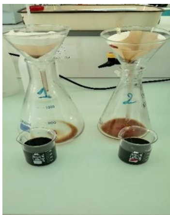
Figure 19 : Étape de filtration du lixiviat
