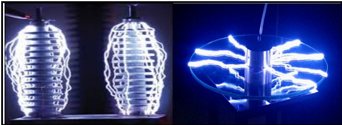
Figure I.10 contournement d'un isolateur
