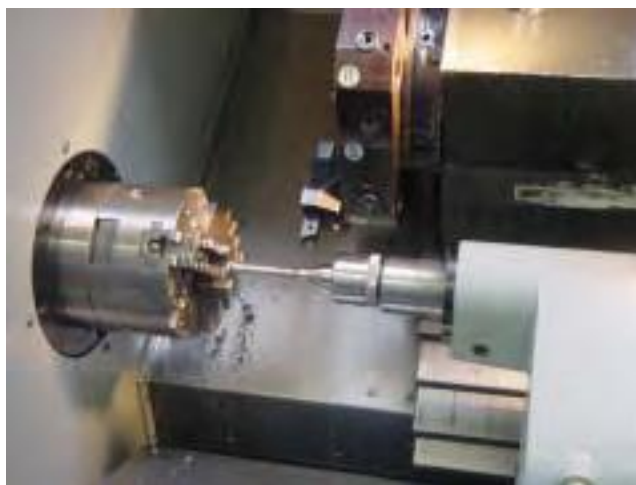
Figure.I.14. Mandrin à 3 mors concentriques associé à une pointe tournante d'un centre de tournage.
