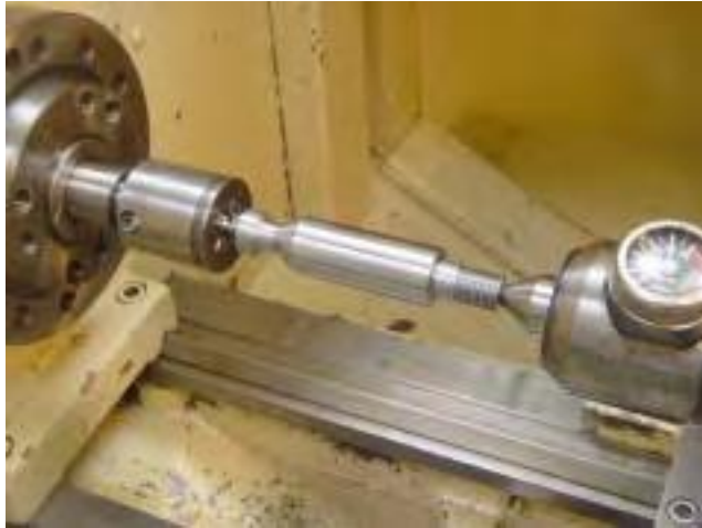
Figure I.15. Montage entre 2pointes une entraînée par la broche de la machine et une pointe tournante sur tour à commande numérique.
