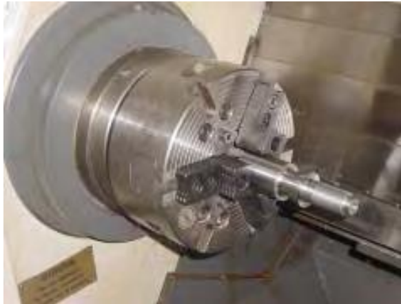
Figure .I.13. Mandrin à 3 mors concentriques sur centre de tournage.
