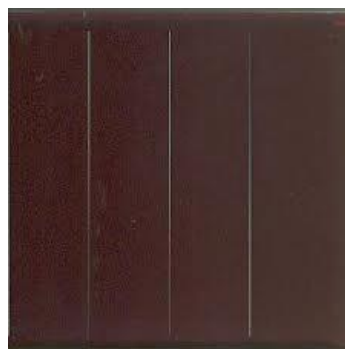
Figure 1.14 Photo d'une cellule amorphe.
