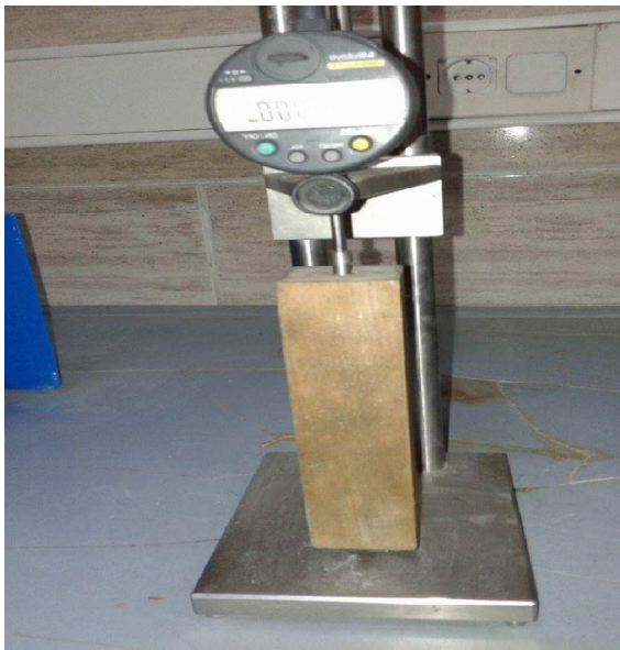
Figure III-19 : Comparateur de Retrait (Laboratoire de Lafargeholcim M'sila)
