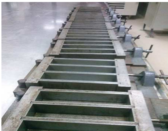
Figure III-11 : Epreuve Prismatique (4x4x16) cm 3
