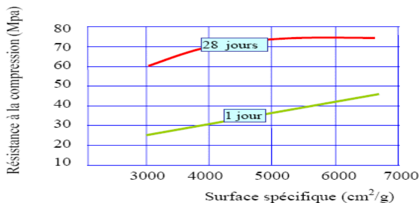
Figure I-16 : Influence de la surface spécifique sur la résistance à la compression.
