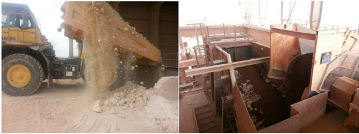
Figure I-4 : Concassage des matières premières au niveau de la carrière.
