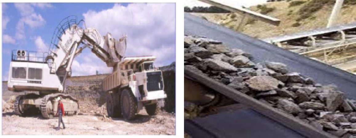
Figure I-5 : Transport par tapis et par dumper.
