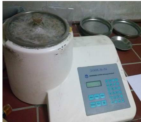
Figure III-4 : Tamiseuse Alpine (Laboratoire de Lafargeholcim M'sila)
