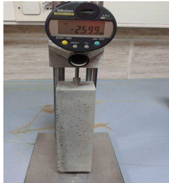
Figure III-19 : Comparateur de Retrait (Laboratoire de Lafargeholcim M'sila)
