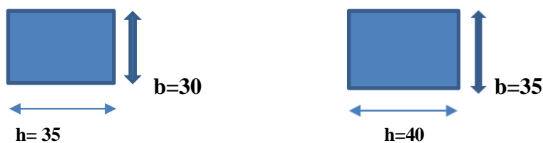
Figure II-1 : Coffrage de Poutres.
