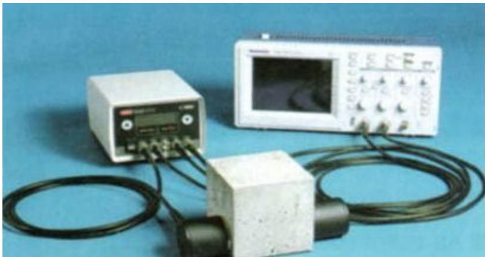
Figure I.17: Appareil d'auscultation sonore 58-E48 avec oscilloscope [3]
