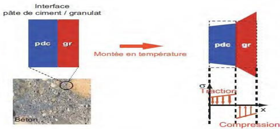
Figure I.3: Mécanismes liés aux incompatibilités pâte-granulat [4]
