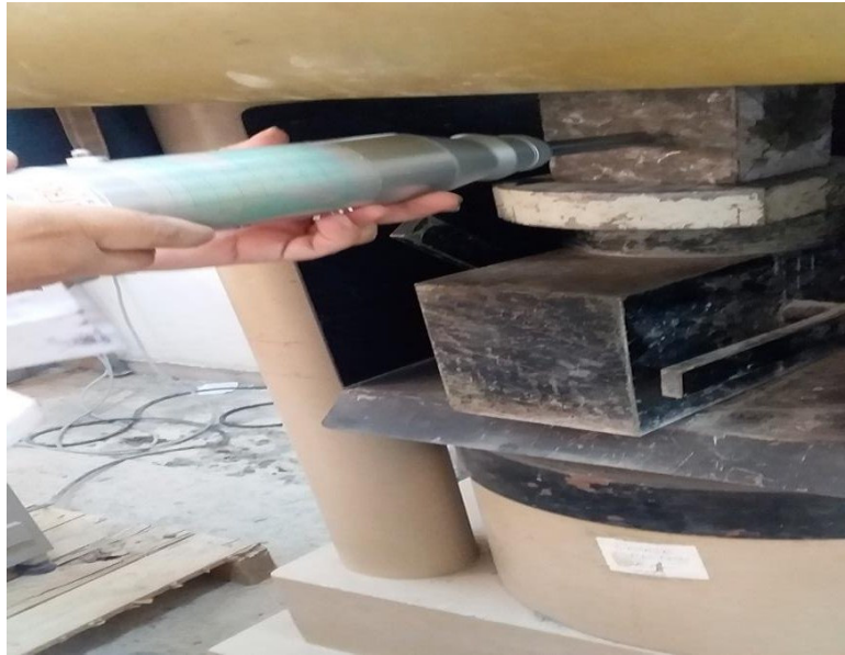
Figure III.27: Principe de l'essai scléromètre.
