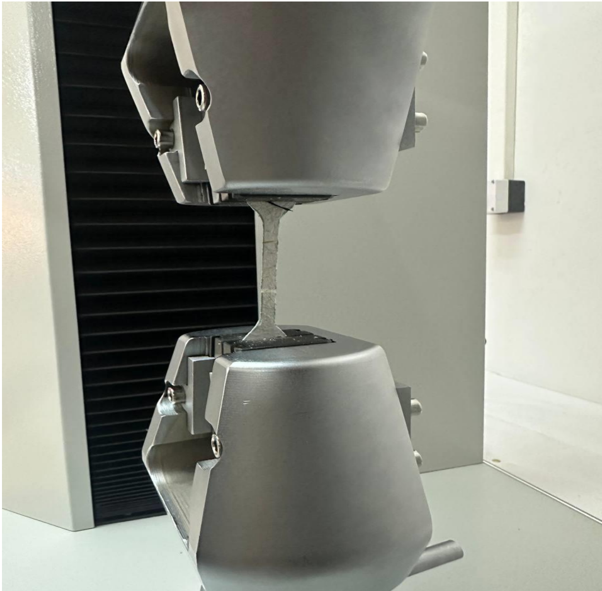
Figure III-27: Maintenez l'échantillon entre les mâchoires de l'appareil
