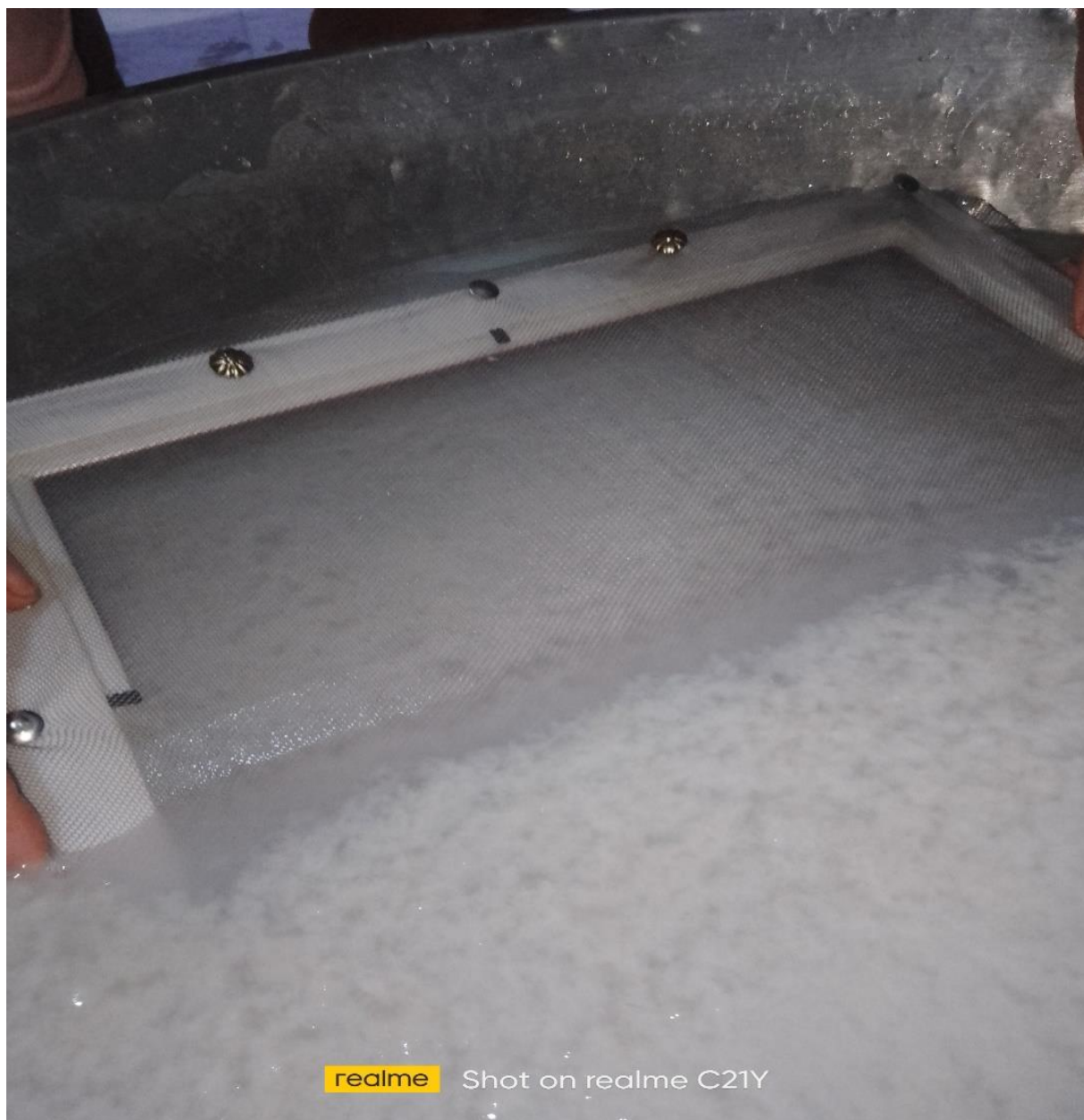
Figure III-17: Répartir la pâte uniformément sur la surface de la grille
