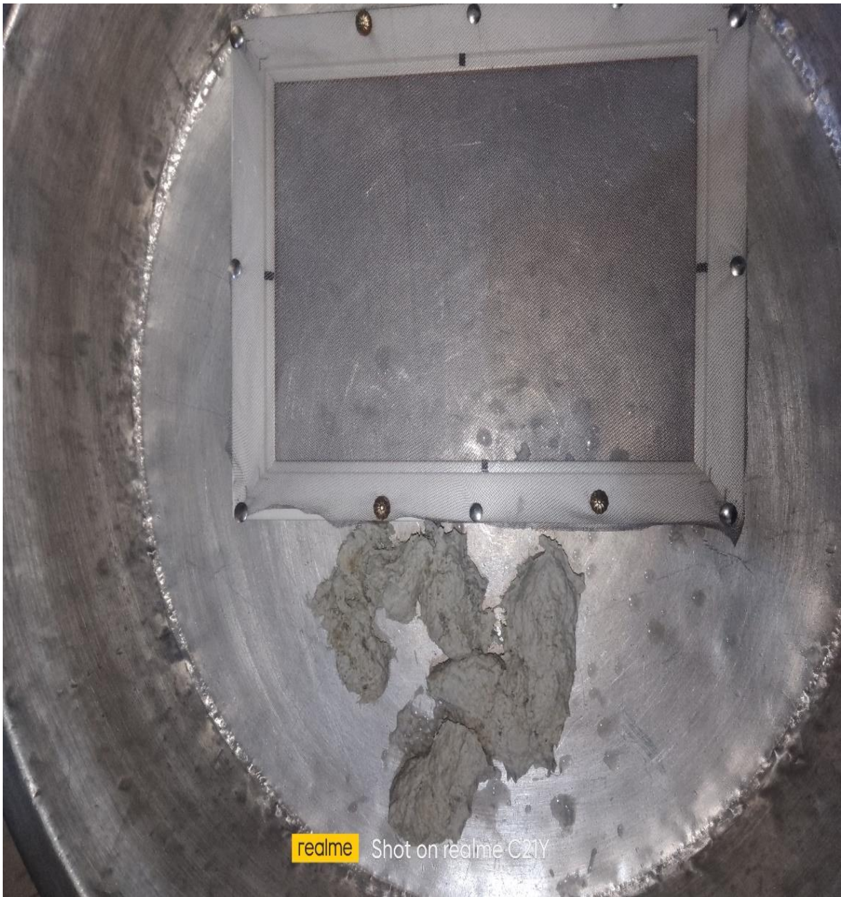
Figure III-16: Préparation du cadre métallique pour former le papier
