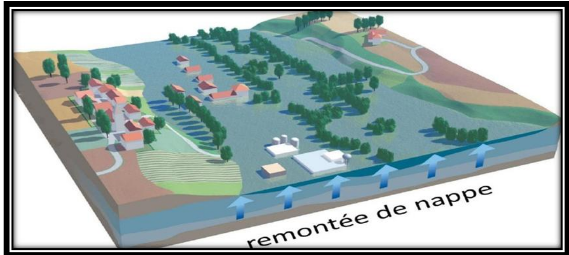
Figure 1: Remontée de nappe
