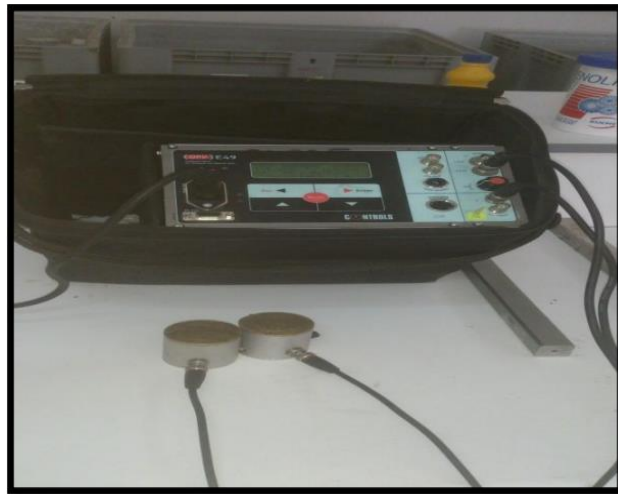
Figure IV. 16 : Appareil à ultrasons hautes performances et ses équipements.
