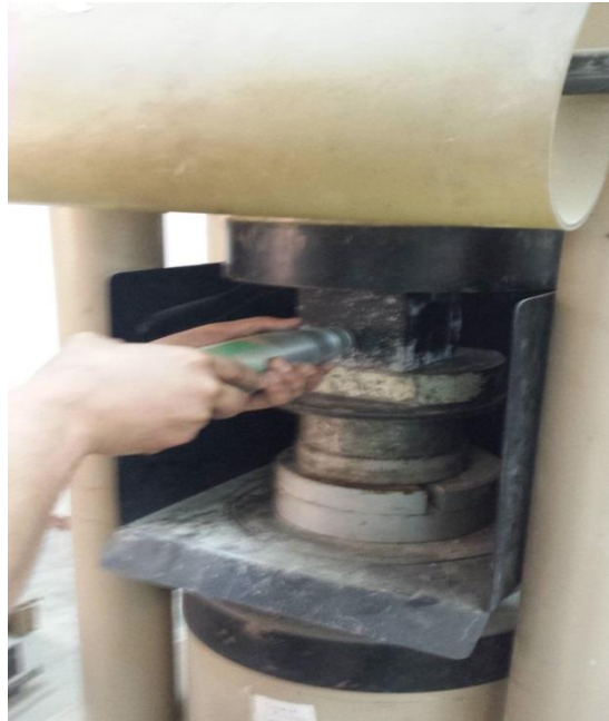
Figure IV. 18: Exécution de l'essai sclérométrique.
