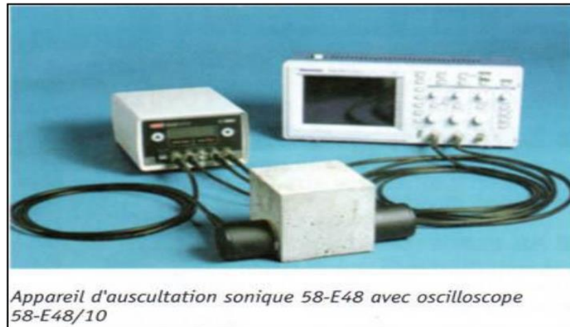
Figure III. 1 : Appareil d'auscultation sonore 58-E48 avec oscilloscope. [92]
