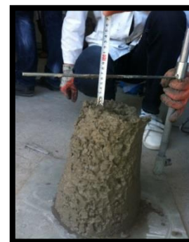
Figure IV. 14 : Mesure de l'affaissement.
