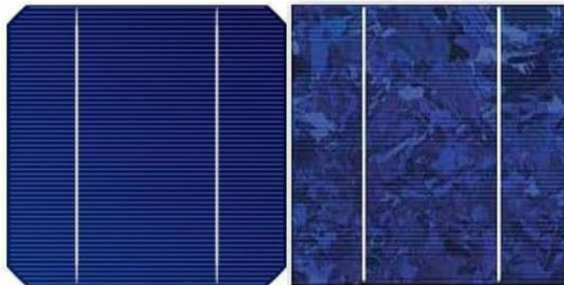
Figure I. 5 : Cellules du silicium monocristallin et multicristallin
