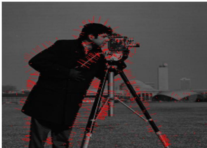
Figure III.19 Application des résultats trouvés sur l'image traité ou les point blancs sont les PI utilisé pour la reconisance des objets mené par des dicripteurs
