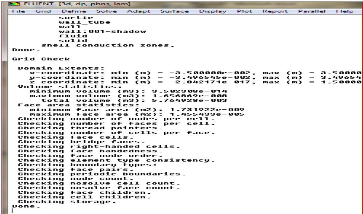
Figure III.18 : vérification du maillage sous Fluent
