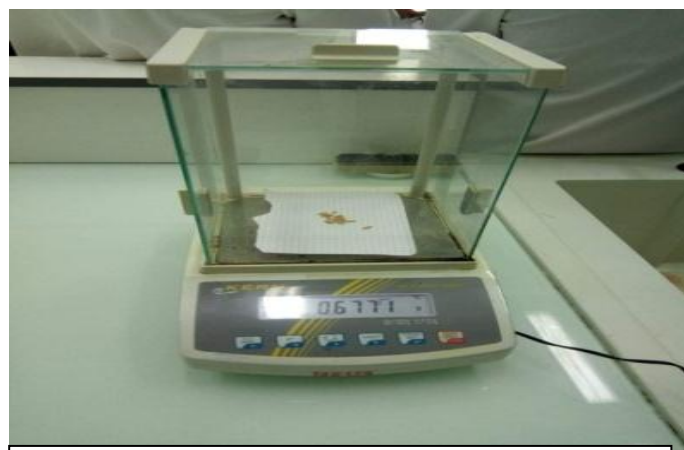
B- prise de mesure de poids des grain de blé dur à l'aide d'une balance de précision
