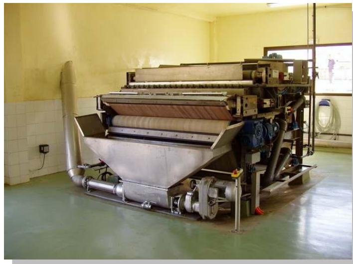
Figure IV.2 : Exemple d'un filtre à bande
