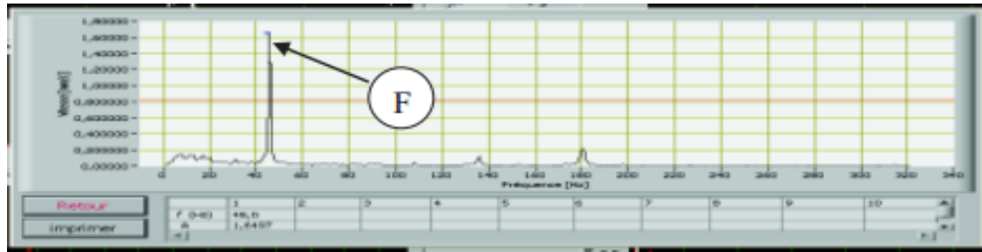
Figure III-11 Spectre de fréquence d'arbre sans fissure
