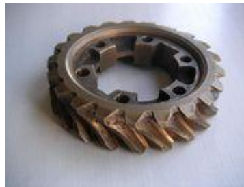
Figure I-19 Dégradation des dents d'une roue dentée
