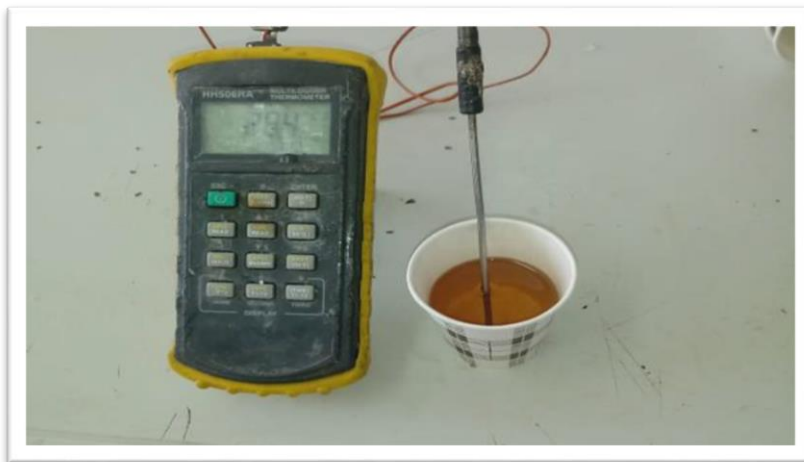
Figure 21 : détermination de temps de réactivité.
