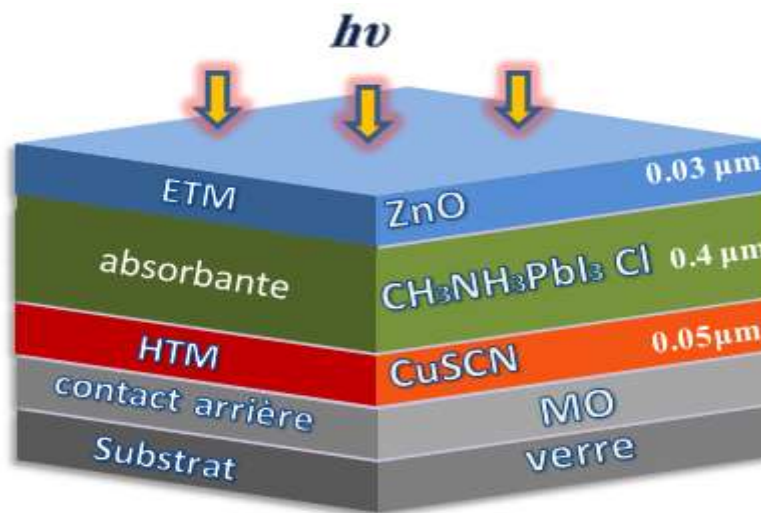
Figure IV.1: Structure de la cellule solaire Pérovskite.
