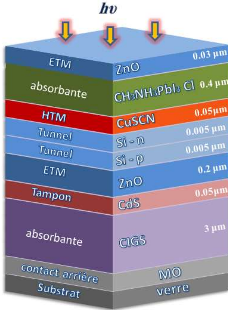
Figure IV.7: Structure de la cellule solaire tandem Pérovskite/CIGS.
