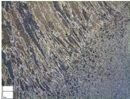
Figure 4.7. Visualisation macrographique d'un cordon de soudure
