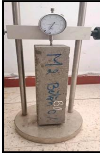
Figure III.16. Dispositif de mesure pour retrait.
