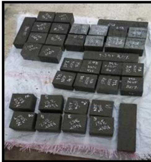
Figure III.8. Etiquetage des différents bétons
