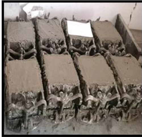
Figure III.7. Confection des bétons étudiés
