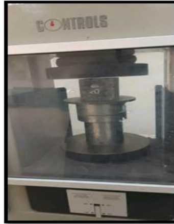
Figure III.12. Machine d'essai de résistance à la compression
