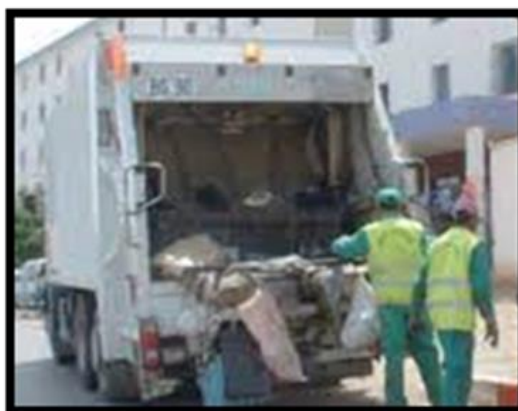
Figure II-3. Collecte des déchets par camion à benne-tasseuse.
