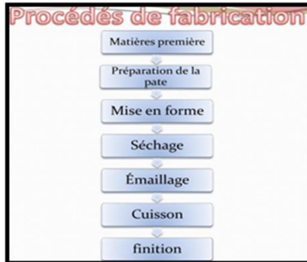
Figure II-11. Procédé général de fabrication des céramiques.
