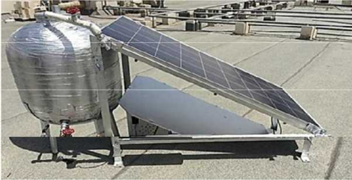
Figure II-35 : Photo du système PVT à eau [37]
