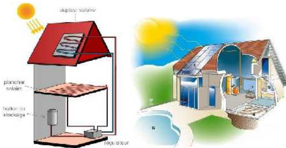
Figure II-13 : Principe du chauffage de bâtiment par plancher solaire direct (PSD) ou hydro-accumulation [25]
