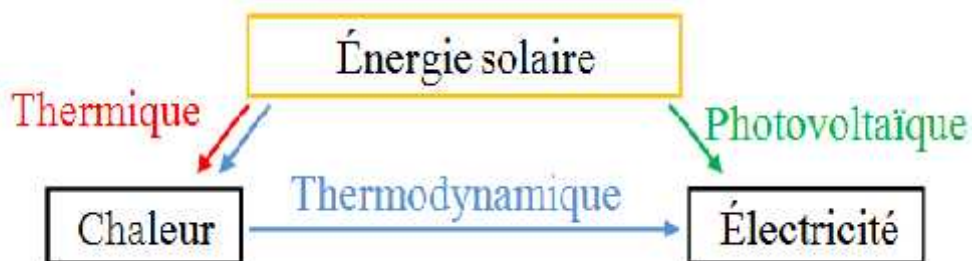
Figure II-4 : Filières de conversion de l'énergie solaire
