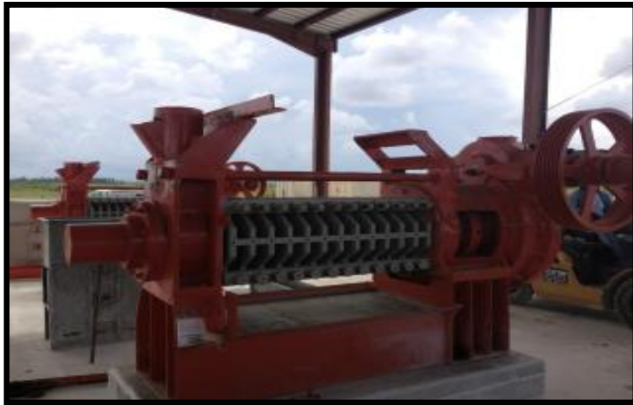
Figure 03 : Assemblage d'une presse à vis continue commerciale (Patel et al. ,2016).
