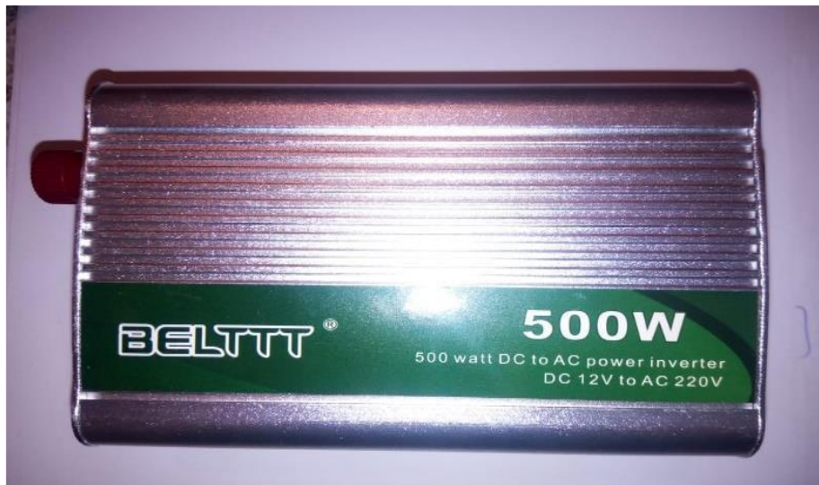
Figure II-11 « Onduleur monophasé 500W ».
