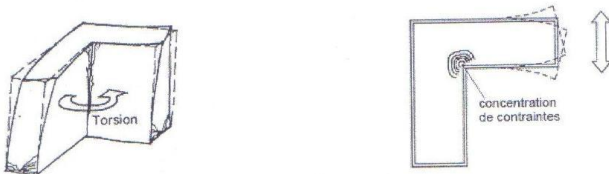
Figure. I-3- Influence de la forme sur la résistance à la torsion, concentration de contraintes dans les angles rentrants.
