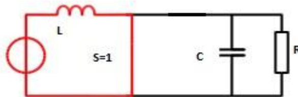
Figure (II.12) schéma équivalent lorsque S=1
