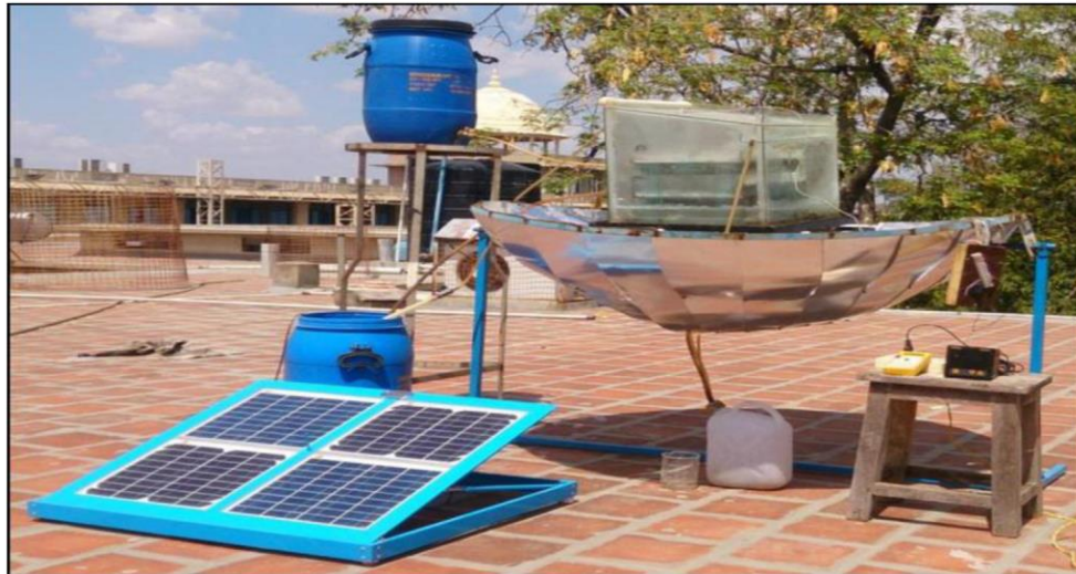
Figure I.13- Distillateur solaire avec un capteur parabolique [18].
