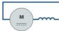
Fig.III.10 : Moteur à excitation sérié
